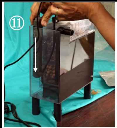
⑪ ヒーターポンプの裏側、センサーはポンプの配管側にセット
